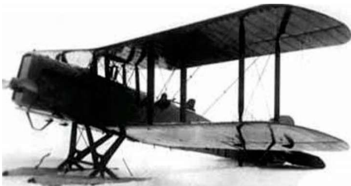
Самолет-разведчик Р-1 с «лобовым» радиатором
